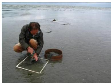
Figure 53. Prélèvement du sédiment dans  $\frac{1}{4}$  de mètre carré
