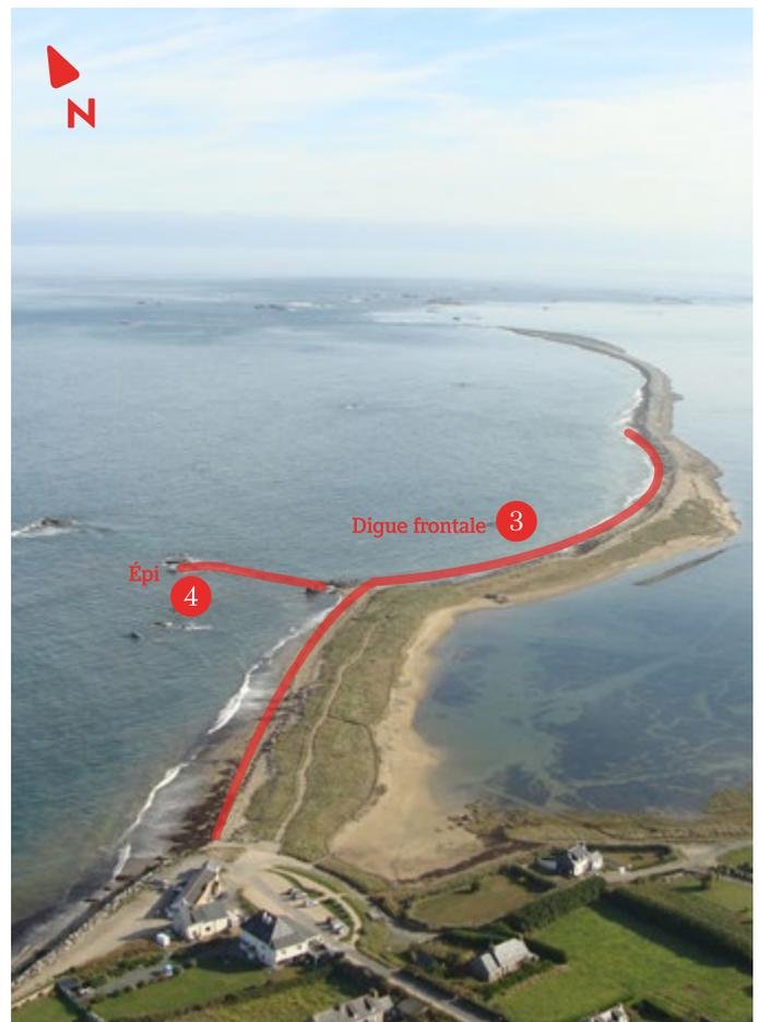
Sillon (1974) **4**. En entravant le transit des sédiments, l'épi et l'enrochement frontal ont entraîné un déficit sédimentaire en aval de l'épi et empêché l'exhaussement naturel de la crête par le jeu des marées. Censée limiter les assauts de la mer, la digue frontale accentuait même la force des vagues et donc l'érosion du sommet.
