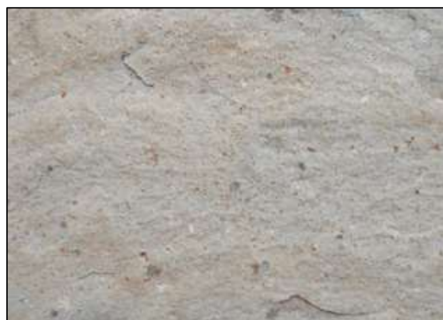
Fig.65 :Texture du grès à grains de sable arrondis
