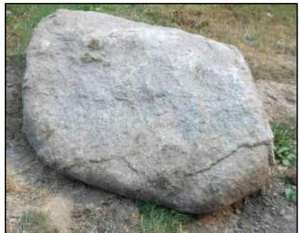
Fig. 143 : Altération de la granodiorite en « pelure d'oignon »
